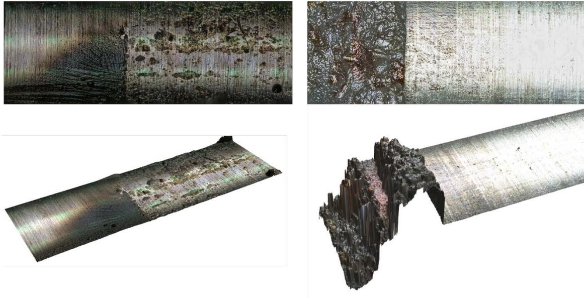
**Abbildung 6-6: Stift mit Ablagerungen aus diffusorartigen Geometrie links mit einer Spaltlänge von 4mm und Stift mit Ablagerungen aus Geometrie mit originalen Auslassbereich (nicht optimiert) rechts mit einer Spaltlänge von 4mm**
