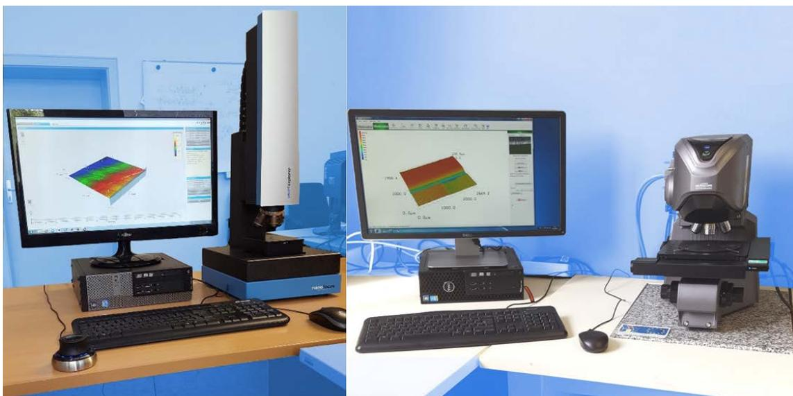
Abbildung 3-1: Konfokal Mikroskop Nanofocus µsurfexplorer links; Laserscanning Mikroskop Keyence rechts
