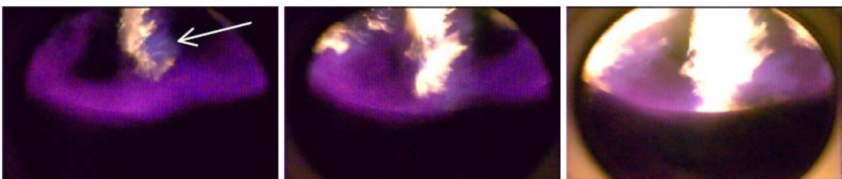
Abbildung 3-1: Start der Vorverbrennungsphase (links) im Übergang zur Hauptverbrennungsphase (rechts); der Pfeil zeigt auf beobachtbare blauschimmernde Chemilumineszenz (entnommen aus Sjöberg, 2001)
